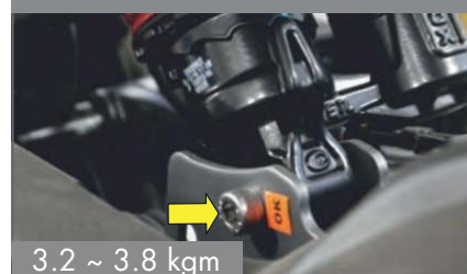
Tornillos caliper
