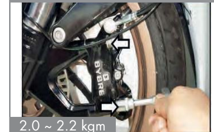
Tornillos caliper
