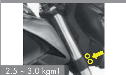
Tornillos de horquilla inferior
