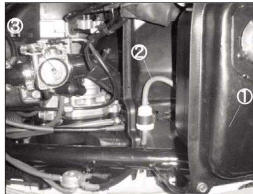
(1) Depósito de gasolina | (2) Tubo de gasolina | (3) Carburador
