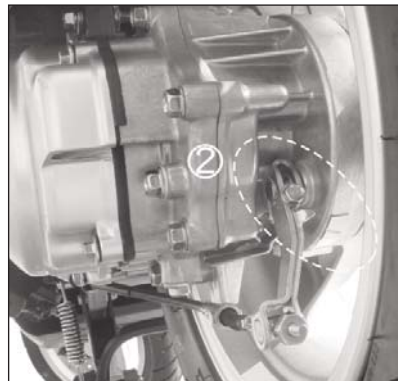
(1) Aguja indicadora del límite de desgaste
