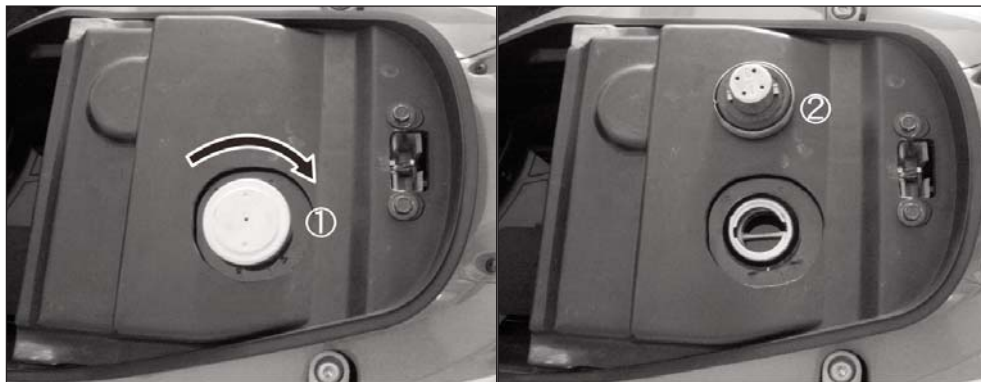
(1) Cierre del tapón del depósito | (2) Tapón del depósito abierto
