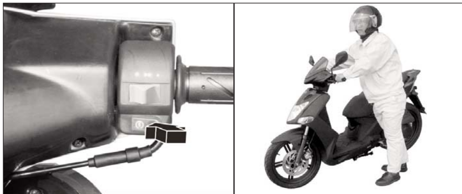
(Izda.) Botón de arranque | (Dcha.) Recogiendo el caballete central
