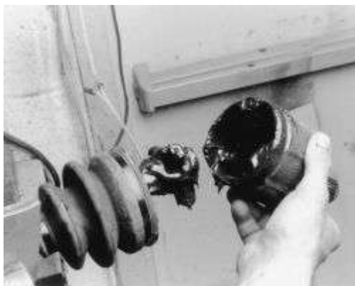
Higo. Higo. 11: Inspección de la vivienda junta homocinética
