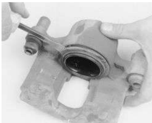
Higo. Higo. 12: Utilice una barra de palanca para hacer palanca con cuidado alrededor del borde de la bota ...
