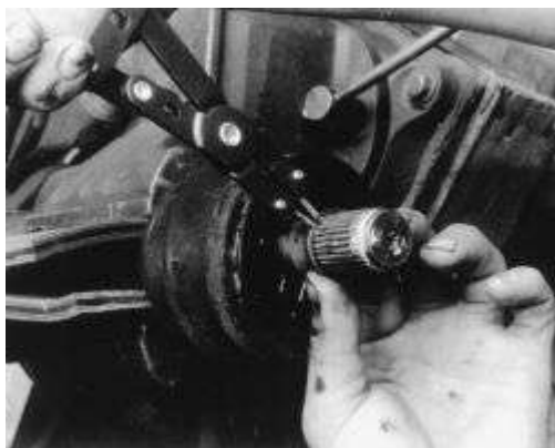
Higo. Higo. 16: Extracción de la snapping interior junta homocinética
