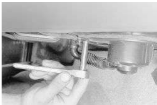
Higo. Higo. 4: .... quitar los tres tornillos de montaje ....
