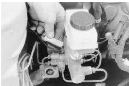
Higo. Higo. 5: Desconectar el sensor de nivel de líquido de frenos ....
