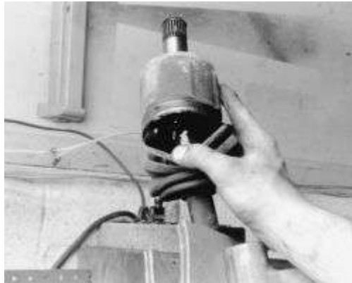
Higo. Higo. 7: Extracción de la CV-arranque de la carcasa de la articulación
