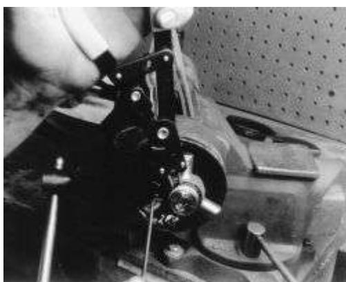
Higo. Higo. 12: Extracción de la snapping exterior junta homocinética
