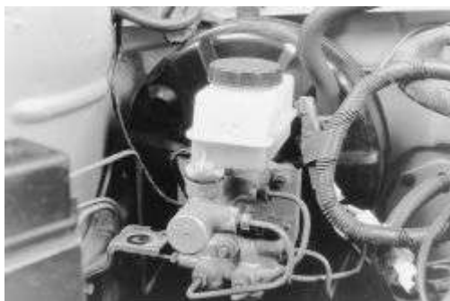
Higo. Higo. 4: El cilindro maestro está unido al servofreno de energía en el cortafuegos
