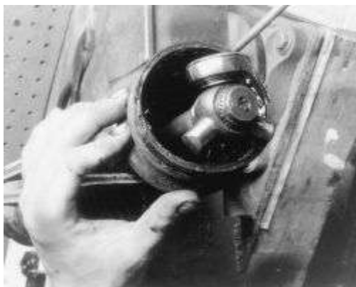
Higo. Higo. 17: Instalación del conjunto de junta homocinética
