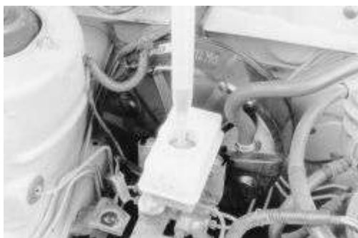
Higo. Higo. 6: .... desviar la mayor parte del líquido de frenos del depósito ....
