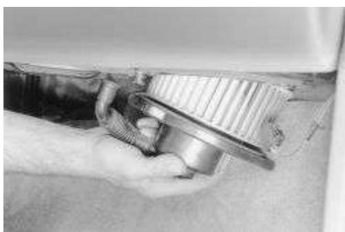
Higo. Higo. 5: .... y bajar el ventilador de la unidad de calefacción
