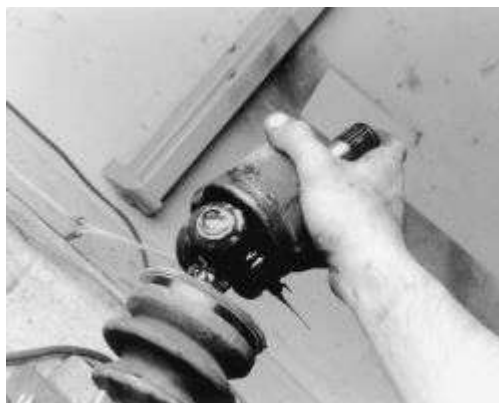
Higo. Higo. 9: Extracción del conjunto de la caja junta homocinética
