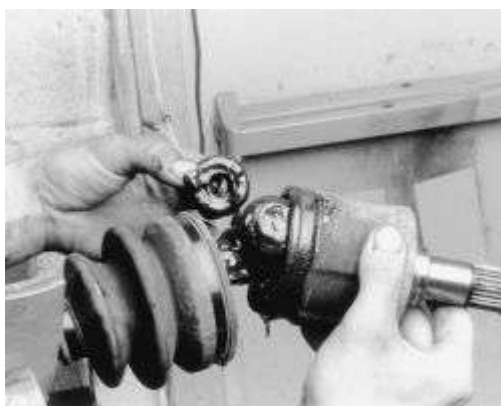
Higo. Higo. 10: Extracción de la junta homocinética
