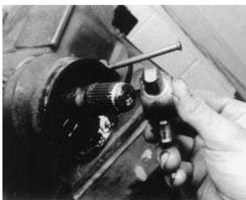
Higo. Higo. 15: Extracción del conjunto de junta homocinética
