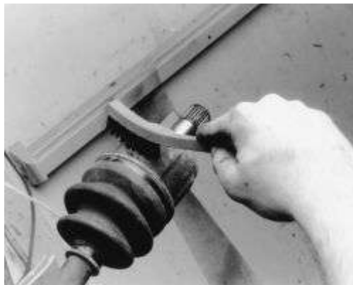
Higo. Higo. 8: Limpiar la carcasa de junta homocinética antes de retirar arranque
