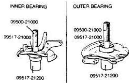
Higo. Higo. 4: Instalación del razas- exterior Excel, Scoupe, Accent y Elantra 1994-1995
