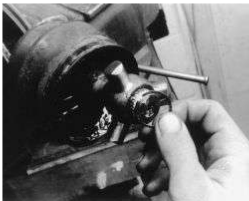
Higo. Higo. 13: Comprobación de la CV-snapring conjunta para el desgaste
