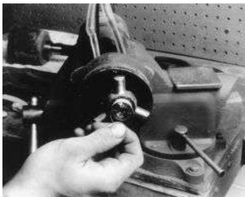
Higo. Higo. 13: Comprobación de la CV-snapring conjunta para el desgaste
