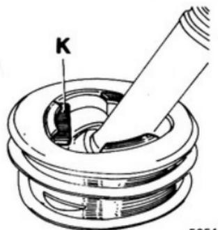
Posicionar los labios del fuelle en las gargantas del árbol de transmisión y sobre la tapa de carcasa.
