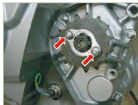
Tornillos seguro sprocket salida 1.1 Kg.-m
