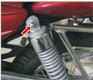
Tuerca amortiguador Trasero Arriba 3.5-4.0Kg.-m Abajo 2.7-3.0kg.-m
