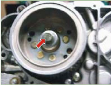
Tornillo rotor 4.5 Kg.-m
