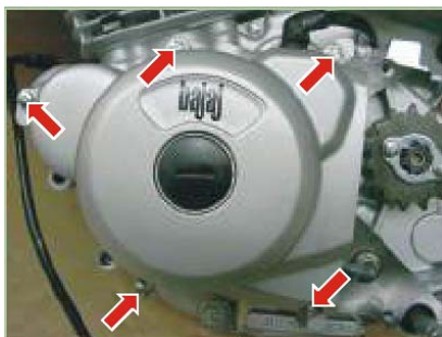
Tornillos tapa magneto 1.1 Kg.-m
