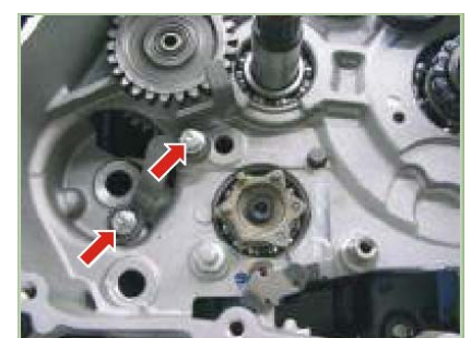
Tornillos guía de leva pedal de arranque 1.1 Kg.-m
