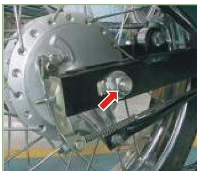
Tuerca eje trasero 8-10 Kg.-m
