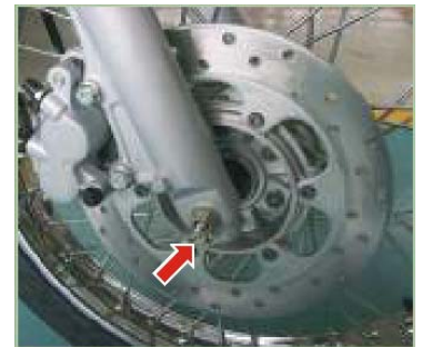
Tuerca eje delantero 4-5 Kg.-m
