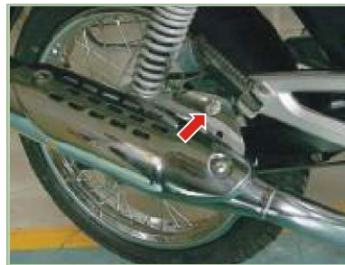
Tornillo silenciador 3.5-4.0 Kg.-m
