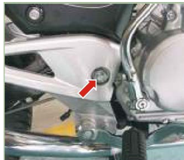
Tuerca eje basculante 8.0-10.0 Kg.-m
