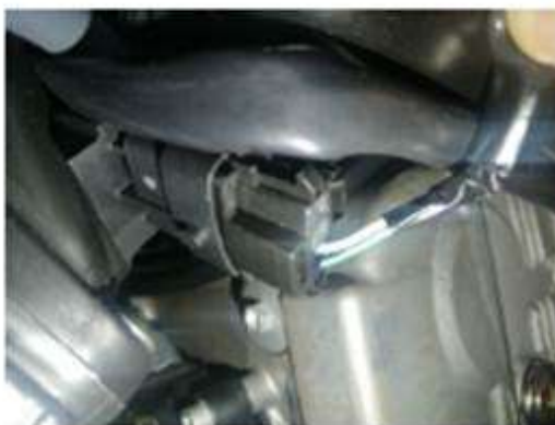
Sensor T-MAP, situado en el lado izquierdo del filtro del aire
