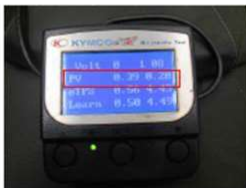
Compruebe PV1 (izdo.) y PV2 (dcho.). Tensión con acelerador abierto y cerrado
