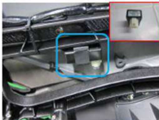
Controlador de luces, situado en parte trasera derecha del bastidor
