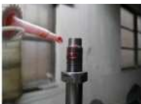
12 Aplique fijador de roscas
