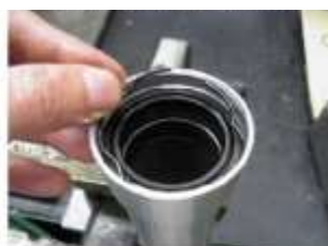
6 Monte el circlip tope
