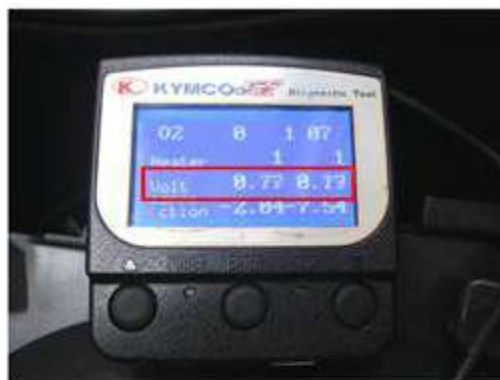
Compruebe tensión sensores O2
