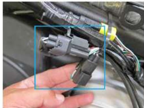
Conectores de los sensores O2
