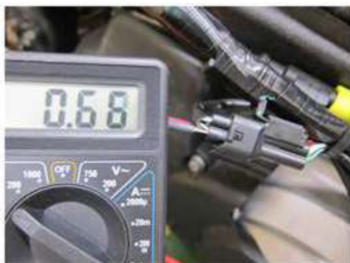
Mida la tensión de los sensores O2
