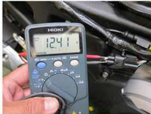
Mida tensión salida en los sensores O 2
