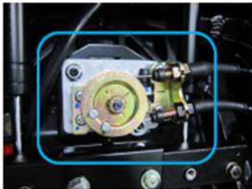
PV (Throttle control grip) situado en la parte posterior del bastidor
