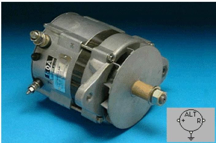
Un alternador es una fuente de voltaje que convierte la energía mecánica en energía eléctrica, la energía mecánica proviene del motor de la máquina.
