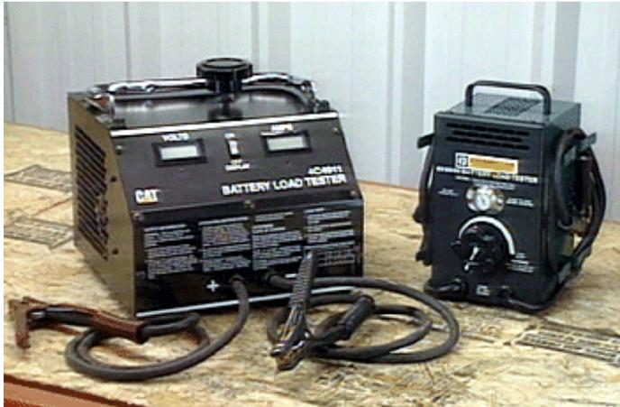
Aquí se encuentran representado el comprobador de carga de baterías Caterpillar 6V4930 (izquierda) y el nuevo comprobador de carga de baterías Caterpillar 4C491 1 (derecha). Ellos pueden utilizarse para comprobar baterías de plomo de seis, ocho, y doce voltios. Ambos comprobadores están diseñados para simular las exigencias impuestas a la batería durante su funcionamiento. La realización de la comprobación de carga puede ayudarlo a establecer si una batería está en buenas o malas condiciones.
