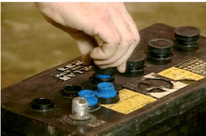
**ADVERTENCIA:** Asegúrese de volver a colocar las tapas de ventilación ANTES de cargar. Esas son tapas de seguridad y pueden evitar una explosión.
