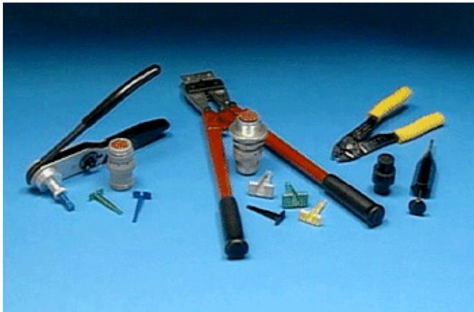
Las herramientas y procedimientos de reparación adecuados son importantes. La utilización de una herramienta de extracción o inserción equivocada puede dañar los contactos o provocar una mala conexión del contacto. Utilizar una herramienta troqueladora equivocada podría dar lugar a una mala conexión entre los contactos y el cable. Esta sección describe las herramientas especiales y los procedimientos de reparación para cada uno de los tres conectores.
