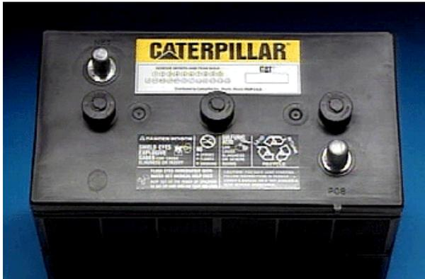
Las baterías convencionales no tienen características externas únicas. Si usted no ve las palabras “Poco mantenimiento/Alta salida” (“Low Maintenance/High Output”) o “Ningún mantenimiento” (“Maintenance Free”) en una batería, entonces es probable que sea una batería convencional.
