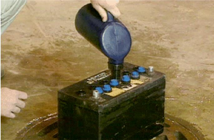
No rellene demasiado la batería, porque puede hacer que el líquido que hay en los vasos salpique y cause lesiones personales. Además, rellenar demasiado la batería también puede crear un desequilibrio en el contenido de electrólito y provocar corrosión en las piezas metálicas adyacentes. Después de agregar agua a la batería, esta debe cargarse.
