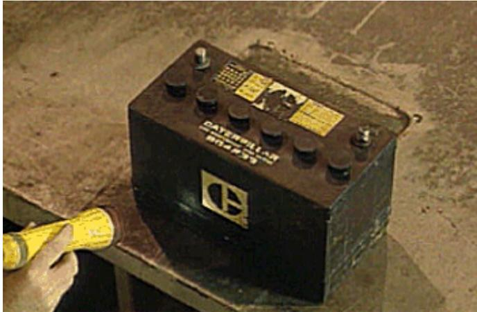
A veces la apariencia visual de una batería puede decirle la razón de su bajo rendimiento. La corrosión alrededor de los bornes puede estar ocasionando un contacto deficiente entre el borne y el cable de la batería.
