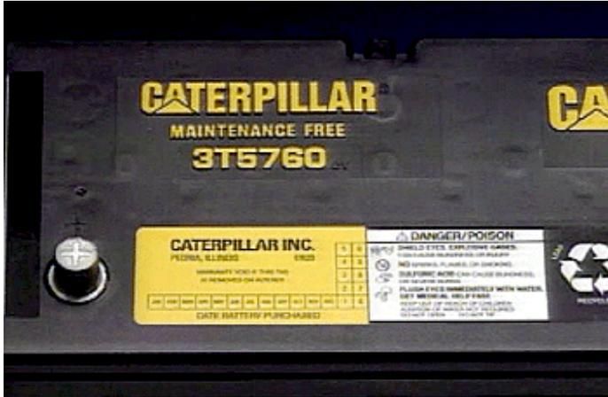
Las baterías que no requieren ningún mantenimiento tienen impreso en la cubierta “maintenance free”. La cubierta y la caja están completamente cerradas y no se tiene acceso al electrólito para comprobarlo. Por lo tanto, las baterías que no requieren ningún mantenimiento no necesitan que se inspeccione el nivel del electrólito.
