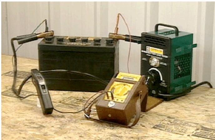
Comprobar la carga de una batería exige que mida la extracción de corriente establecida para la batería y el voltaje de la misma al final de la prueba. Si el comprobador de carga que está utilizando no posee incorporados los instrumentos de medición de voltaje y de corriente necesarios, utilice el multímetro digital y el amperímetro de mordaza junto con él, para medir así las extracciones de corriente y de voltaje.
