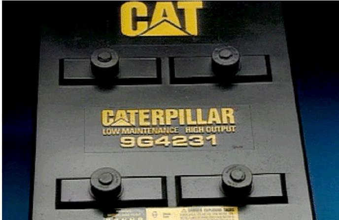
Antes de proceder a la comprobación de carga de una batería, realice una comprobación del estado de carga de la batería y cargue la batería si es necesario.
