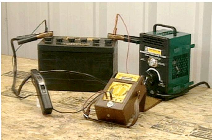
La carga de prueba adecuada para una batería es la mitad de la capacidad nominal de amperios de giro en frío (CCA) de la batería.
