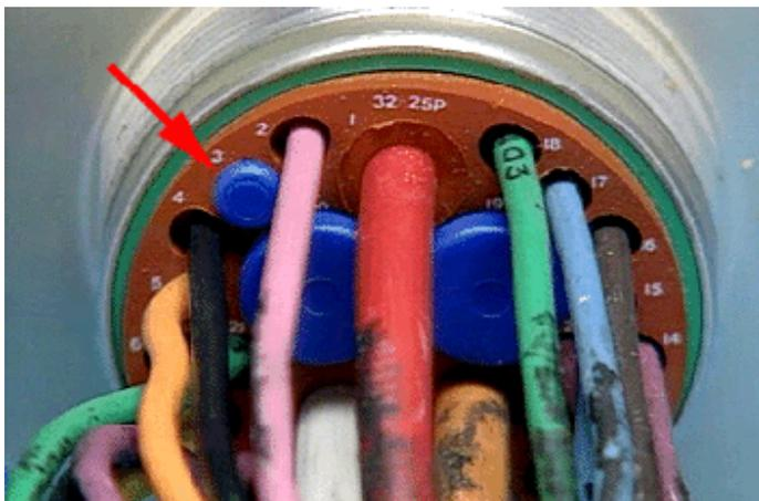
Los conectores están sellados ambientalmente con una junta. Los cables individuales poseen arandelas aislantes. Los tapones de sellaje (flecha) están insertados en los enchufes hembra que no están en uso para evitar la entrada de impurezas y de humedad.
