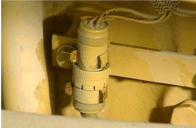
El conector Deutsch brinda un servicio confiable en ambientes severos. Está bien sellado, y con simples herramientas manuales puede dársele mantenimiento y repararlo con mucha facilidad.
