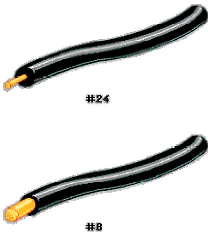
El diámetro del cable está expresado por un numero de calibre. Mientras mayor sea el calibre, más delgado será el cable. Aquí se muestra un cable delgado (calibre #24) un cable pesado (calibre #8).
