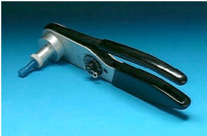
La herramienta troqueladora manual CAT 1U5804 se utiliza para troquelar los contactos del conector Deutsch™ al cable. Esta herramienta también puede utilizarse para troquelar los contactos del conector CE de calibre 12 al 18. La herramienta posee un selector de calibre de cable, que se ajusta para que coincida con el calibre del cable que será troquelado.
