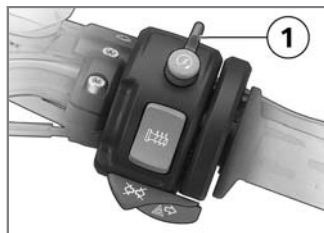
1 Interruptor de parada de emergencia
