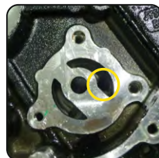
Salida Bomba de Evacuación
