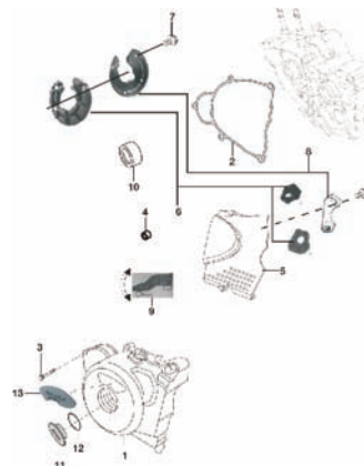
FIGURA N° 14 : CUBIERTA VOLANTE / CUBIERTA CADENA
