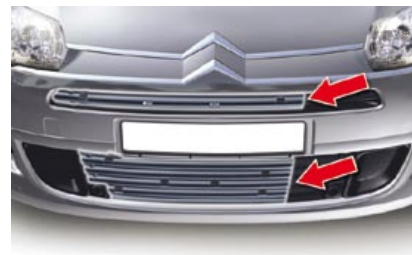
Después del montaje
