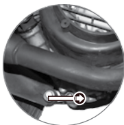
Imagen 14. Ubicación del tornillo de drenado.
