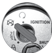
Imagen 25. Apagar el motor.
