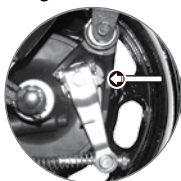
Imagen 19. Desgaste del freno delantero.
