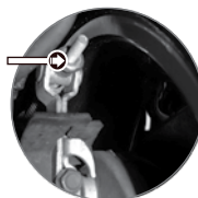
Imagen 18. Ajuste de la palanca del freno trasero.
