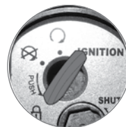
Imagen 26. Bloqueo de dirección.
