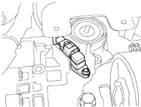
Fig. 33: La identificación de la ubicación de salida de componentes del sensor de velocidad Cortesía de HYUNDAI MOTOR CO.
