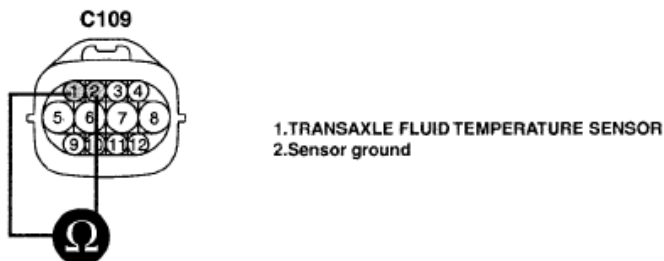
Fig. 22: Medición de la resistencia entre los terminales "1" y "2" del "CAMBIO CON SENSOR DE TEMPERATURA DEL FLUIDO"
