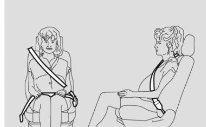
La correa del cinturón de seguridad no debe quedar torcida. La parte superior debe pasar en el hombro y pasar en diagonal por el tórax. La parte de bajo debe quedar junto a la cadera y no en el abdomen del ocupante. No utilice dispositivos (resortes, cierres, etc.) que impidan el contacto de los cinturones de seguridad con el cuerpo de los ocupantes.
