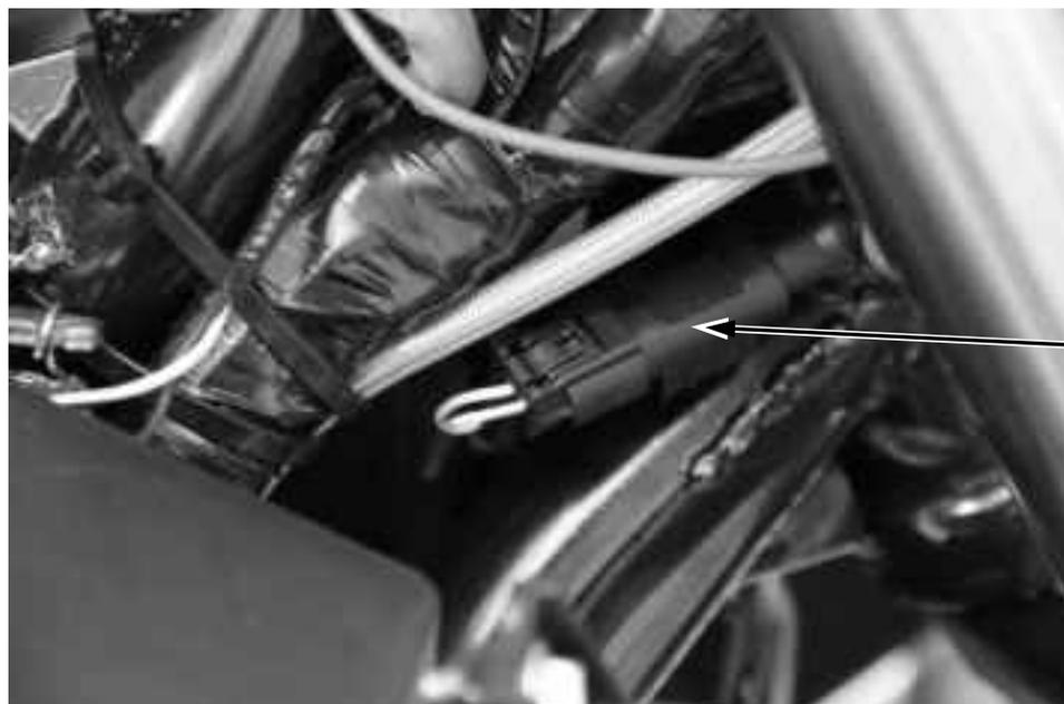
Conector del sensor de velocidad
