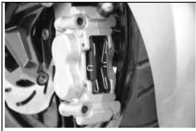
La pastilla de freno se debe cambiar con un nuevo forro cuando alcance el límite de desgaste.
