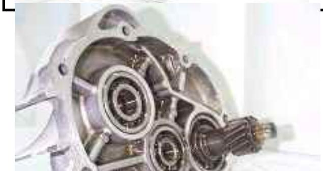
Monte un nuevo rodamiento final del eje en la tapa de la caja de cambios.
