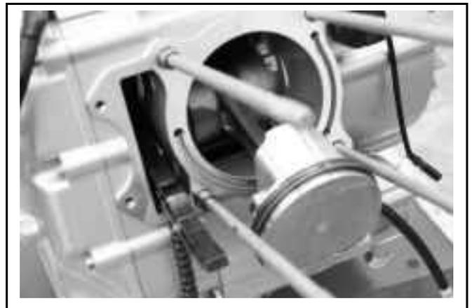
Instale clavijas y una nueva junta.
