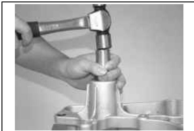
Coloque un nuevo rodamiento de la horquilla trasera y un nuevo tirador (6303) sobre la horquilla trasera.
