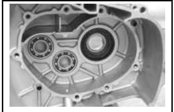
Instale el contraeje, el eje final y el engranaje final de tracción.
