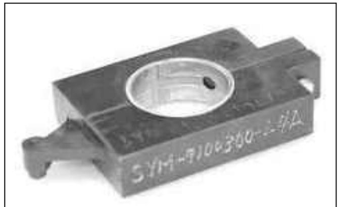
Alinee el canal de aceite del rodamiento principal y el cárter.
