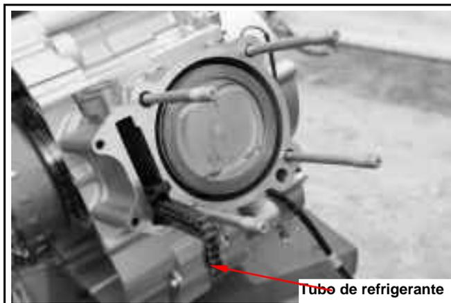
Cubra los orificios del cárter y la cadena de la leva con un paño.
