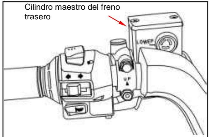
Quite la tapa del cilindro maestro y el diafragma. Cargue líquido de frenos de gran calidad de la misma marca en el cilindro maestro. Limpie el disco de freno sucio.
