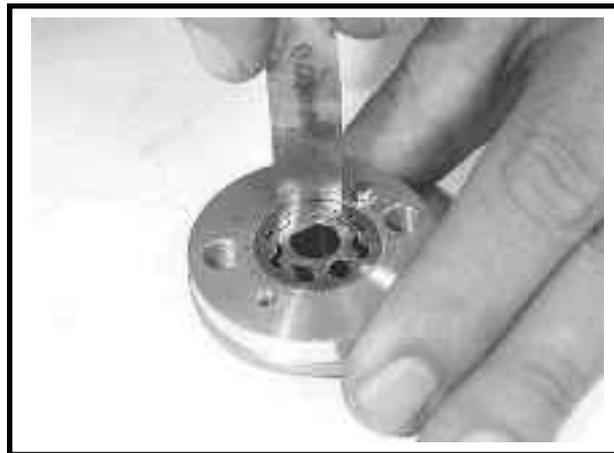
Compruebe la holgura entre los rotores interior y exterior.
