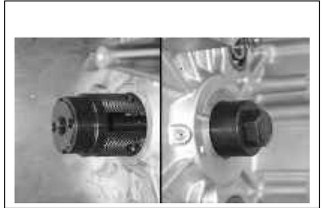
Fije el extractor con la herramienta universal de sujeción y saque el rodamiento principal.
