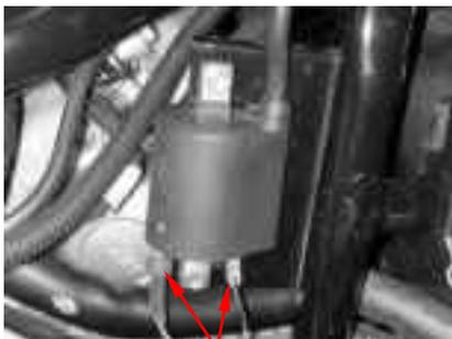
Medición de la resistencia de la primera bobina del circuito
