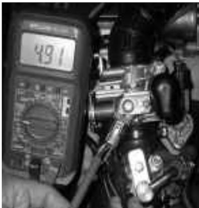
Medición del voltaje de funcionamiento
