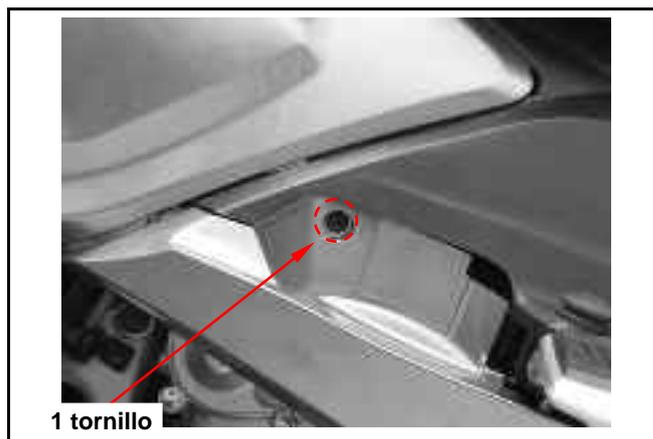
Suelte 2 tornillos del extremo superior de la cubierta lateral.
