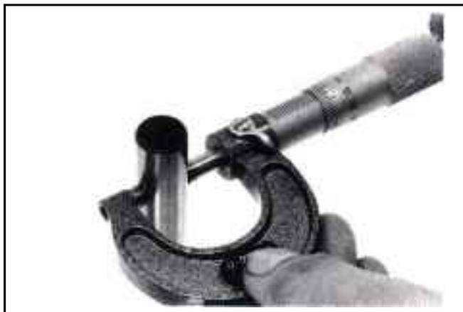
Mida el diámetro interior del perno de conexión del extremo pequeño
