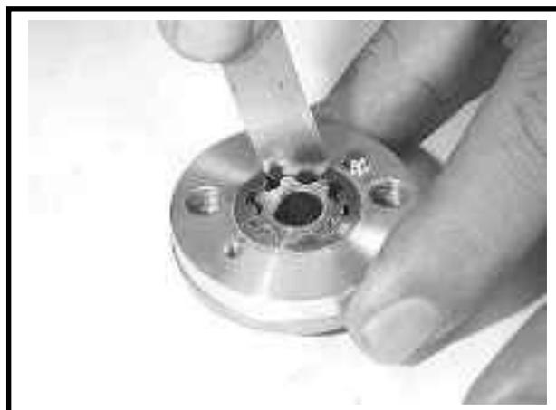
Compruebe la holgura entre el lateral del rotor y el cuerpo de la bomba
