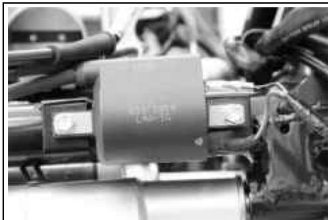
Cambio de la bobina de encendido
