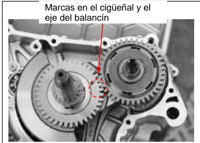
Monte el cárter derecho en el cárter izquierdo. Apriete los pernos del cárter derecho.
