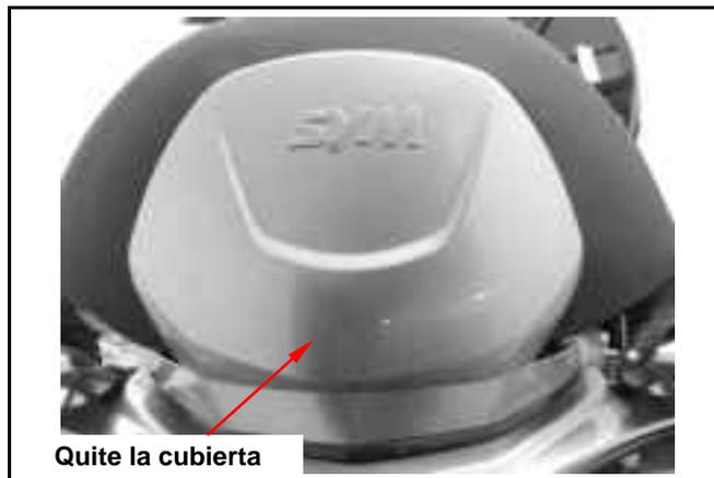
Suelte los tornillos del lado izquierdo y derecho y el central de la parte posterior de la cubierta central.
