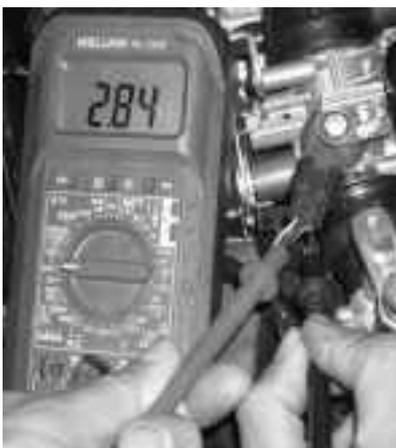
Terminales de medición del voltaje de salida
