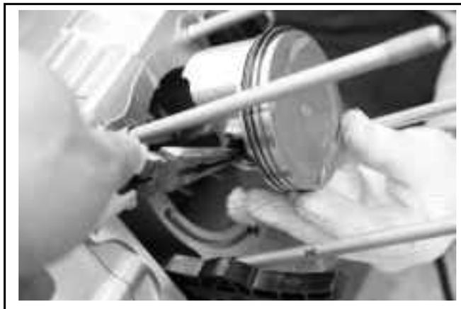
Quite la junta del cilindro y la clavija.
