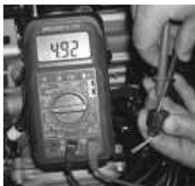
Medición del voltaje de funcionamiento
