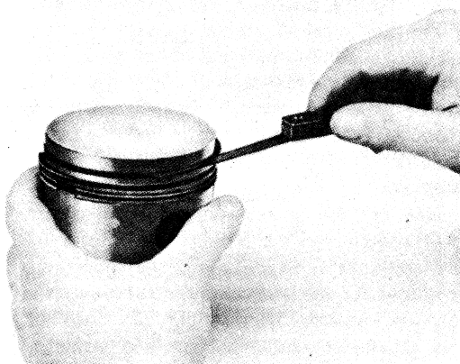
Verificación de la holgura lateral del anillo de un pistón
