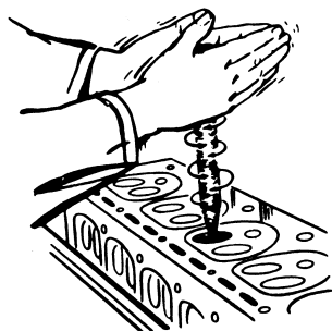
Asentado manual de las válvulas
