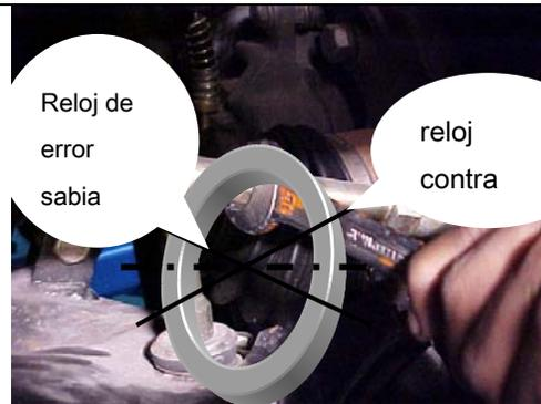
Girar ambas barras de acoplamiento en la misma dirección aproximadamente 30 grados para cada 1-grado de error de desalineación de la dirección.
