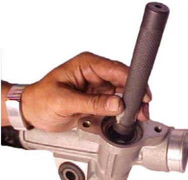
Para la eliminación y volver a montar el piñón de cojinete exterior utilizar la herramienta especial.
