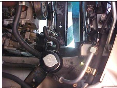
Retire las mangueras de conexión de dirección de alimentación de la bomba de dirección asistida.
