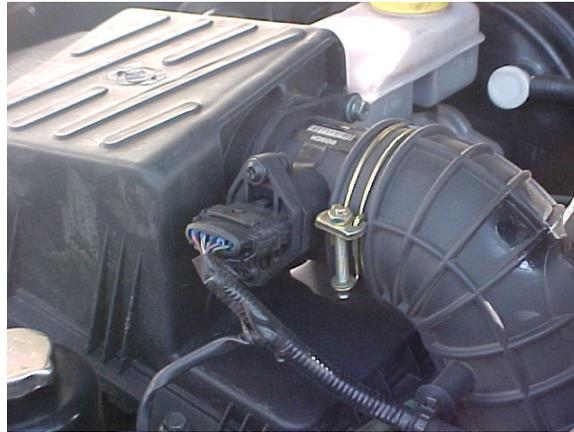
El sensor HFM combina dos funciones. Se monitoriza el flujo de aire y también controla la temperatura de entrada de aire de manera que la corrección de densidad se lleva a cabo y también se mantiene la temperatura de la película caliente.
