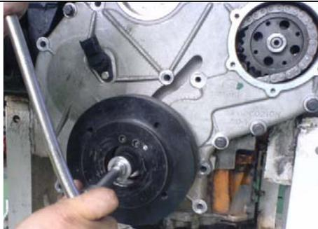
Retire la polea de amortiguador
