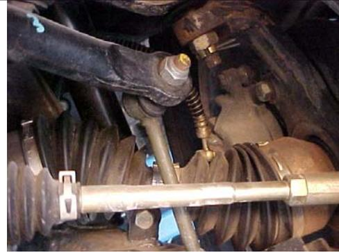
Aflojar las tuercas de fijación de rótula de dirección y también retirar los clips de sujeción exteriores fuelle.
