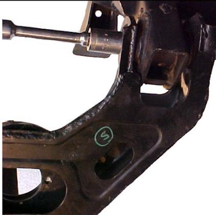
Aflojar los tornillos de montaje del brazo inferior y las tuercas laterales superior del brazo. de modo que el movimiento del brazo inferior es libre
