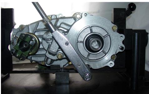
Desmontaje - Adaptador, la flecha de entrada y el Montaje de Portador
