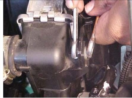
Retirar los pernos de montaje del condensador.
