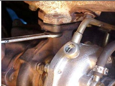
Retire el tubo de escape desde luego el codo. (Acceso sólo es después de levantar en una de dos columnas o en un pozo y el uso de una extensión con UJ).
