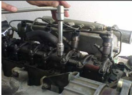
Retire el conjunto del eje de balancín
