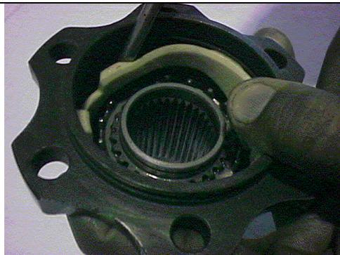
Retire la caja exterior de plástico haciendo palanca una pata fuera de la ranura grande en la carcasa del embrague. Mantenga la oreja y pasar a la siguiente. Es más fácil comenzar con los tetones opuestos el que se ajuste a la ventana de la jaula interior de acero.
