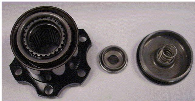
Retire la tapa de extremo y el resorte pista de cojinete. Retire el anillo interior del cojinete y el retén.
