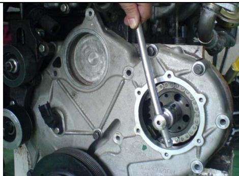
Afloje y retire la tuerca de bloqueo de alta presión de la bomba.
