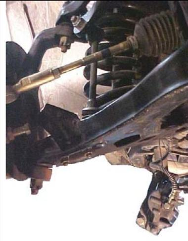
Retire el conjunto de pinza sin desconectar el tubo de freno.
