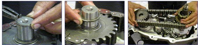
Desmontaje - la cadena de transmisión
