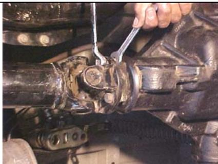
Retire el eje de la hélice de la brida acompañante
