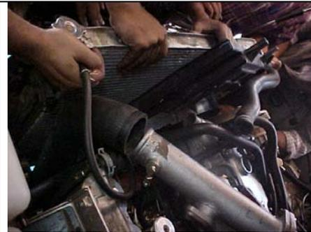
Retire los pernos de montaje del radiador y quitar el radiador junto con el tubo de conexión al tanque sin pérdida.
