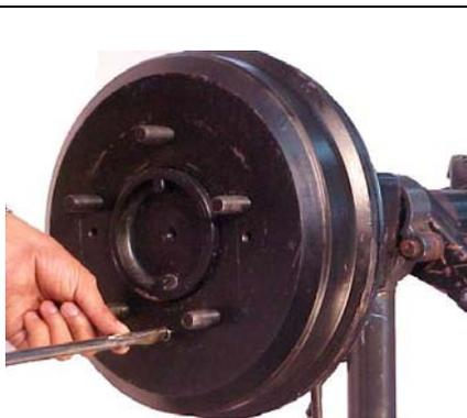
Retire el tambor de freno después de aflojar los dos tornillos
