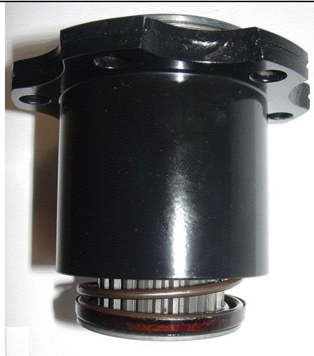
Instalar el conjunto de leva y seguidor en la carcasa del embrague exterior desde el interior.
