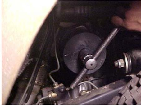
Retire la rueda lado derecho delantal. Retire el filtro de aceite con el MST 545
