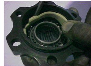
Instalar la jaula exterior de plástico en la ranura grande en la carcasa de embrague exterior. La jaula puede ser más fácil de instalar si las pestañas en el cada lado del corte se instalan por primera vez.
