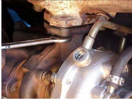
Retire el montaje de 3 tuercas turbocompresor.
