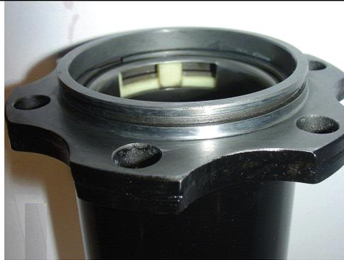
Retire la jaula interior de acero presionándola sobre la espiga de la jaula exterior (en la ventana). Levantar la jaula interior hacia afuera, no lo incline.
