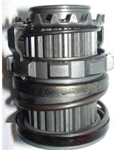
Deslizar el conjunto de leva y seguidor de la carcasa de embrague exterior.
