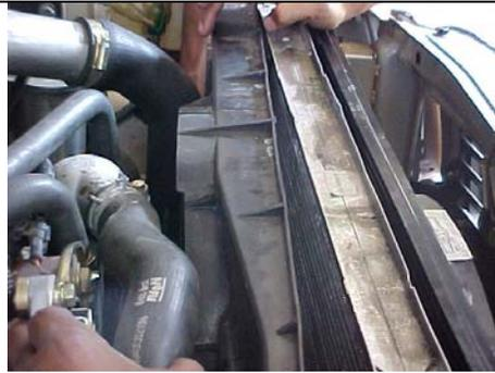
Retire la cubierta del ventilador.
