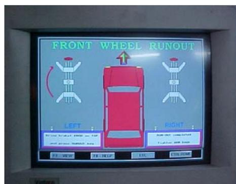
Mueva el neumático en la dirección como se muestra en la pantalla sosteniendo el sensor, después completando la mitad pulse la tecla de rotación agotado en el sensor de completar la rotación restante.
