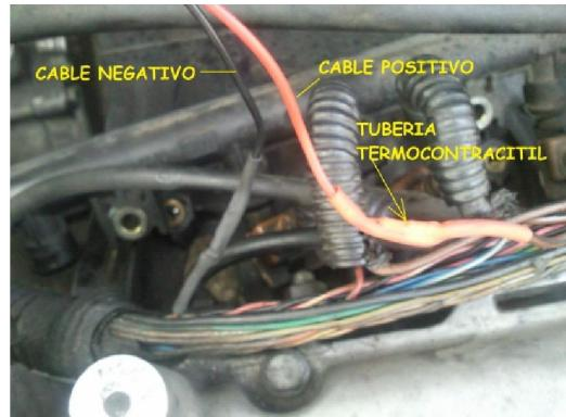
Concluida la colocación de los enchufes, cubra con cinta adhesiva el ramal. Esto se hace para ordenar el cableado y para protegerlo.
