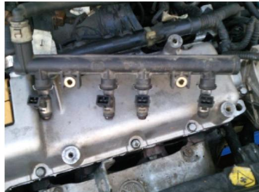
Para quitar los inyectores de la flauta: con la ayuda de un pequeño destornillador quite el clip y hale en el sentido indicado en la imagen, aplique lubricante WD-40 entre el inyector y la flauta para su fácil remoción; luego hale hacia abajo el inyector. Llévelos a limpiar.
