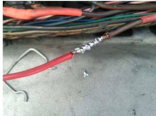
Esta operación laharemos también con el cable negativo, para el caso del inyector 1 el color del cable es amarillo, este valor es una variante ya que en el resto de los inyectores los colores de los cables negativos cambian. Aquí observamos el empalme ya soldado. Proceda a colocarle el tubo termo contráctil.
