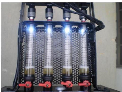
**Prueba de atomizado:** Como su nombre lo dice consiste en observar la calidad del atomizado. En el tablero de mando del banco de prueba existen opciones que simulan el funcionamiento de los inyectores como si estuviesen en el vehículo, permitiéndonos una comprobación más real.
