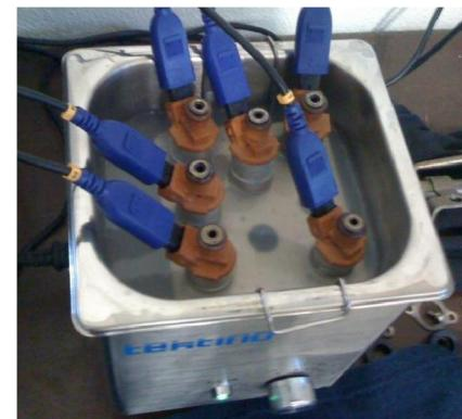
Después que los inyectores salen de la limpieza por ultrasonido, deben ser sometidos nuevamente a todas las pruebas anteriores y una vez que están correctamente ajustados y calibrados, se procede a la instalación de los componentes o KIT y así estarán listos para ser montados de nuevo en el vehículo.
