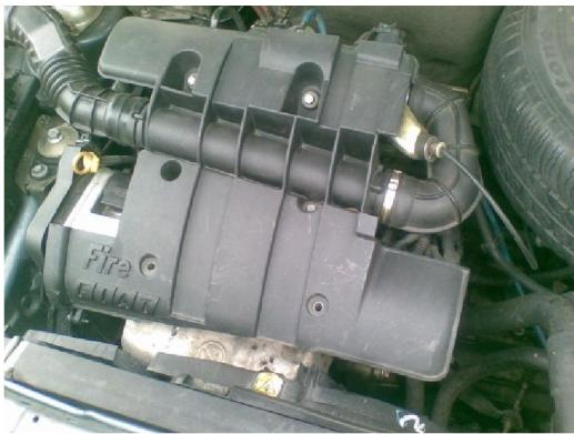
Se desconecta el borne negativo de la batería (-) y se retira la cubierta que cubre el tapa válvulas y el cuerpo de aceleración con un dado de 10 mm. con el motor a temperatura ambiente teniendo mucho cuidado de quitar la manguera de vacío que se conecta en el cuerpo de aceleración ya que ambos son de un plástico algo frágil.
