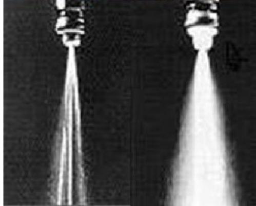
Esta acumulación de depósitos puede cambiar drásticamente el funcionamiento de los inyectores y por lo tanto el buen funcionamiento del vehículo.
