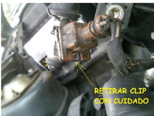
Verifique que el conector del inyector este completamente fijo, si este estuviese flojo reemplace el inyector. Desconecte los enchufes de los inyectores; para ello retire el cuidadosamente el clip con una herramienta. Guarde el clip en un sitio seguro.
