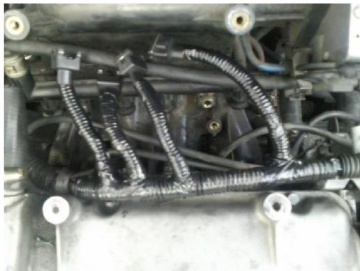
Como protección extra cubra el ramal y los cables con tubería flexible del tipo corrugado y cinta adhesiva. Coloque la cubierta plástica del ramal.
