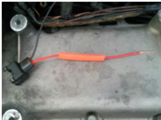
Despojamos los extremos de los cables, tanto en el enchufe como en el cable del ramal, introduzca una sección de tubería termocontráctil -o termoencogible- para cubrir el empalme. Este método es más seguro que la cinta adhesiva.
