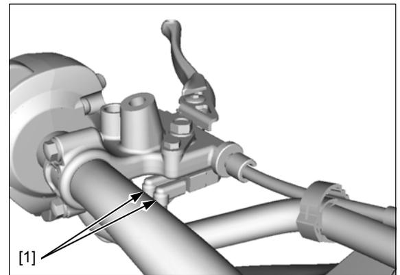
**PARKING BRAKE CALIPER (CRF1000D)**
