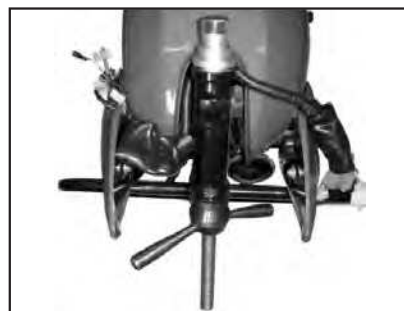
Instalador de tazas superior e inferior de la dirección en el cuadro
