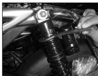
Herramienta para ajustar el resorte del amortiguador trasero
