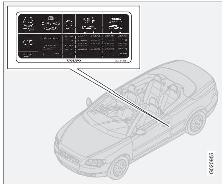
La placa de presión de neumáticos situada en el montante de la puerta del lado del conductor especifica la presión que deben tener los neumáticos en diferentes condiciones de carga y velocidad.
