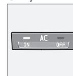
**ON:** El aire acondicionado está conectado. El sistema se regula automáticamente. De esta manera, el aire que entra se enfriá y deshumedece.
