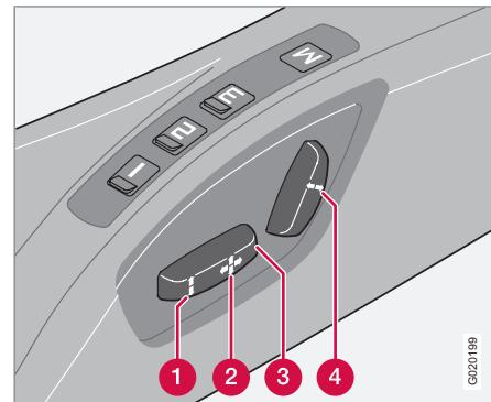
El asiento puede ajustarse algo después de haber abierto la puerta con el mando a distancia, sin haber introducido la llave en la cerradura de contacto. El asiento puede ajustarse en todo momento con el encendido en la posición I o II.
