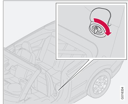
Si el sistema eléctrico del automóvil deja de funcionar temporalmente, el maletero puede abrirse mecánicamente con la llave extraible del mando a distancia. Para obtener información sobre la extracción de la llave, ver la página 125.
