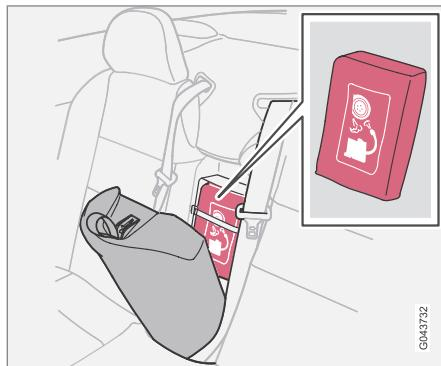
El kit de reparación de neumáticos se utiliza para reparar un pinchazo y para comprobar y ajustar la presión. Está compuesto por un compresor y un recipiente con un sellador. El kit se utiliza para realizar reparaciones provisionales. La botella con el líquido sellador debe cambiarse antes de la fecha de caducidad o después de utilizarse.
