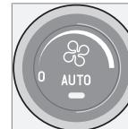
La función **AUTO** regula automáticamente el climatizador para obtener la temperatura seleccionada. La función automática regula la temperatura, el aire acondicionado, la velocidad del ventilador, la recirculación y la distribución del aire.
