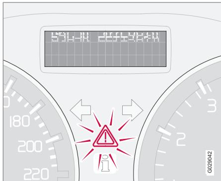
Si el automóvil ha sufrido una colisión, puede aparecer el texto **MODO ACCIDENTE CONSULTE MANUAL** en la pantalla de información. La aparición de este mensaje significa que ha disminuido la funcionalidad del vehículo. El modo accidente es una función de seguridad que se activa cuando existe la posibilidad de que la colisión haya dañado una función importante del automóvil como, por ejemplo, conductos de combustible o sensores de alguno de los sistemas de seguridad o del sistema de frenos.
