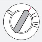
Se desconecta el bloqueo del volante. Pueden utilizarse algunas funciones. El sistema eléctrico del motor no está conectado.
