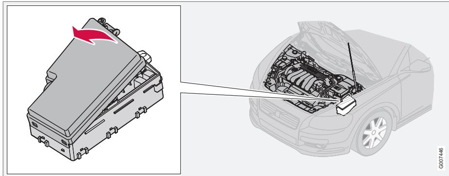
Tiene 36 posiciones de fusibles. Sustituya el fusible gastado por otro del mismo color y amperaje.
