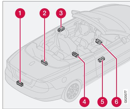
El sistema "Keyless" tiene una serie de antenas integradas distribuidas en el vehículo:
