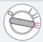
Se activa el motor de arranque. La llave se suelta al arrancarse el motor y vuelve a la posición de conducción.
