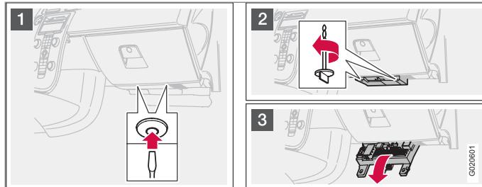
Tiene 50 posiciones de fusibles. Los fusibles están situados debajo de la guantera. También tiene espacio para fusibles de repuesto. La herramienta para el cambio de fusibles está en la caja de fusibles y relés, en el compartimento del motor, ver la página 243.
