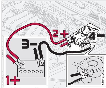
Si la batería del automóvil se descarga, puede utilizarse la corriente de una batería independiente o la batería de otro automóvil. Compruebe siempre que las pinzas de los cables puente estén bien sujetas para que no se generen chispas durante el intento de arranque.
