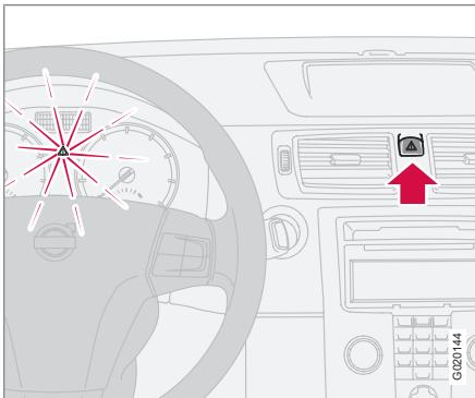
Utilice las luces de emergencia (destellan todos los indicadores de dirección) cuando el automóvil está parado en un lugar en el que puede suponer un peligro o un obstáculo para el tráfico. Pulse el botón para conectar esta función.
