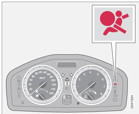
El símbolo de advertencia del instrumento combinado se enciende al girar la llave a la posición **I**, **II** o **III**. El símbolo se apaga después de 6 segundos si el sistema de airbags no tiene averías.
