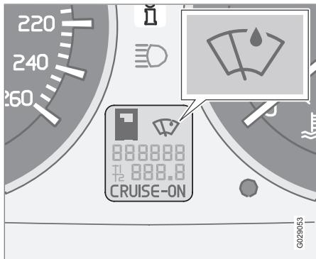
El sensor de lluvia detecta la cantidad de agua que cae sobre el parabrisas y activa los limpiaparabrisas de manera automática. La sensibilidad del sensor de lluvia se ajusta con la rueda (C), ver la página 64.
