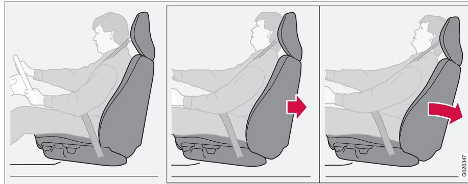
El sistema WHIPS (Whiplash Protection System) consta de respaldos que absorben la energía de un impacto y reposacabezas adaptados al sistema en los asientos delanteros. El sistema se activa en colisiones por avance según el ángulo de incidencia, la velocidad y la naturaleza del vehículo con el que se choca.
