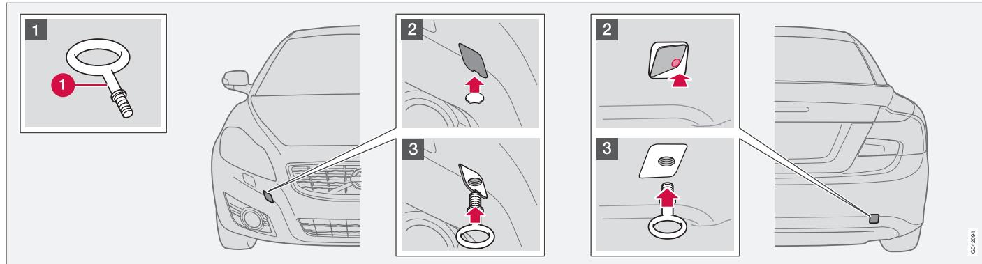
La anilla de remolque se enrosca en un orificio protegido por una tapa en el lado derecho de los parachoques delantero y trasero.
