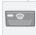
Para eliminar rápidamente el vaho y el hielo del parabrisas y de las ventanillas. Las ventanillas se ventilan a alta velocidad. Cuando está conectada esta función, se enciende la luz del botón del desempañador.
