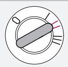
La posición de la llave para conducir. Se conecta todo el sistema eléctrico.
