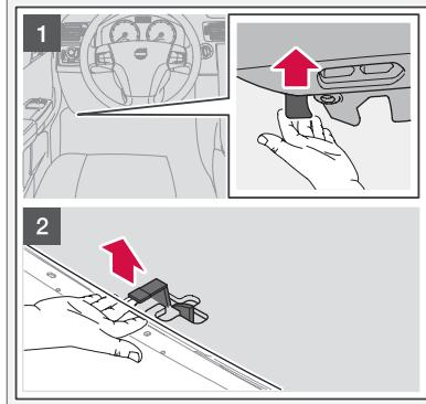
1. Tire del abridor situado en el extremo izquierdo debajo del salpicadero. (En automóviles con volante a la derecha, el abridor está situado a la derecha). Al desengancharse el cierre, se oye un sonido.
