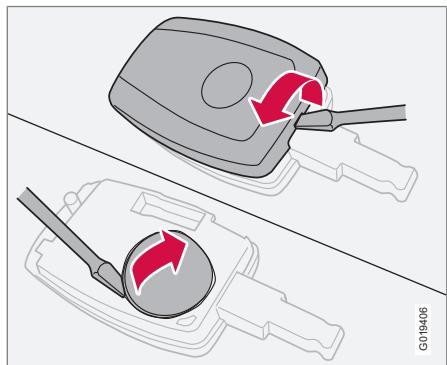
1. Coloque el mando a distancia con los botones hacia abajo y levante la tapa utilizando un pequeño cincel.
