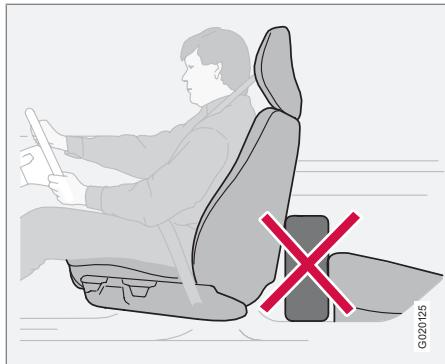
*No coloque en el piso detrás del asiento del conductor o del acompañante objetos que puedan impedir el debido funcionamiento del sistema WHIPS.*
