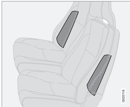
Colocación de airbag laterales.
