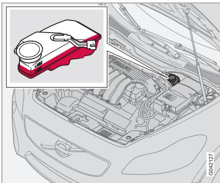
El líquido de freno y embrague tiene un depósito común<sup>2</sup>. El nivel debe estar entre las cotas de **MIN** y **MAX**. Compruebe el nivel de forma periódica. Cambie el líquido de freno cada dos años o cada dos intervalos de servicio programado.
