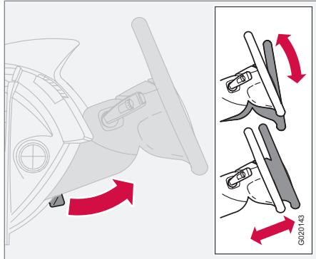
El volante puede ajustarse en altura y en profundidad.
