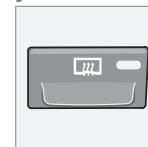
Utilice la función de calefacción eléctrica para hacer desaparecer el hielo y el vaho de la luneta trasera y los retrovisores. Si pulsa el botón una vez, se inicia el calentamiento de la luneta trasera y los retrovisores al mismo tiempo. La luz del botón se enciende para indicar que la función está activa.
