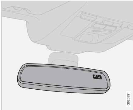
Si hay una luz muy intensa detrás del automóvil, esta luz puede ser reflejada por el espejo retrovisor y deslumbrar al conductor. Accione el mando cuando resulte molesta la luz detrás del automóvil.
