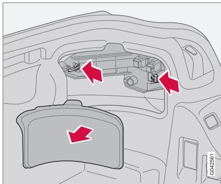
Todas las bombillas de las luces traseras se cambian dentro del compartimento de carga.
