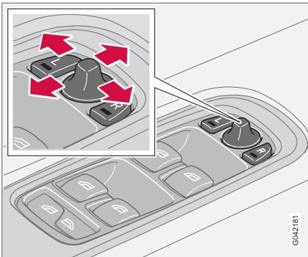
Los mandos para ajustar los dos retrovisores exteriores están situados en la parte delantera del apoyabrazos del conductor. Los retrovisores pueden controlarse con el encendido en la posición I y II.
