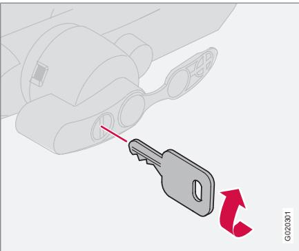
2. Compruebe que el mecanismo está en posición de apertura girando la llave hacia la derecha.
