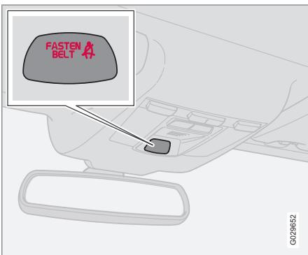
A los ocupantes que no lleven puesto el cinturón de seguridad, se les avisa de que se lo abrochen mediante señales acústicas y lumi-
