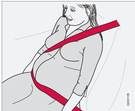
Durante el embarazo se debe utilizar siempre el cinturón de seguridad, pero es importante hacerlo de la forma correcta. El cinturón debe ir ajustado al hombro, con la banda diagonal entre los pechos y a un lado del vientre.
