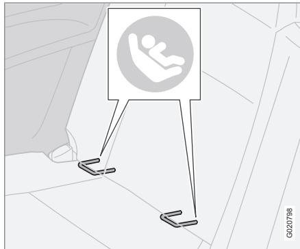
Los puntos de fijación del sistema ISOFIX están ocultos en la parte inferior del respaldo del asiento trasero en las plazas laterales.
