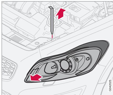
Todas las bombillas delanteras (a excepción de las luces antiniebla) se cambian desconectando y sacando el portalámparas desde el compartimento del motor.
