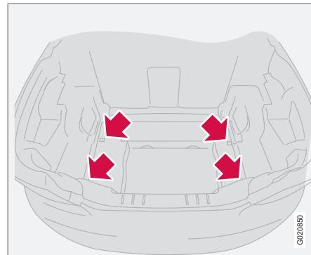
El automóvil dispone de cuatro o más anillas para fijar correas o cuerdas. En el concesionario Volvo puede adquirir correas que se adaptan a estas anillas.
