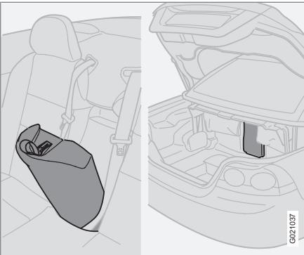
Para poder transportar objetos ligeros de gran longitud, el automóvil dispone de un compartimento detrás del panel central<sup>1</sup> del respaldo del asiento trasero.
