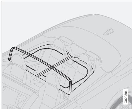
El cortavientos puede utilizarse al conducir con capota abierta para reducir las turbulencias de aire en el habitáculo.
