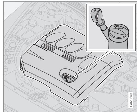
Varilla de nivel, motores diésel. (El D5 tiene una varilla de nivel electrónica.)
