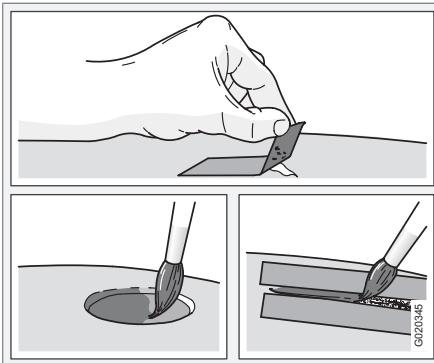
Antes de comenzar los trabajos de retoque de la pintura, el automóvil debe estar limpio y seco y a una temperatura por encima de 15 °C.
