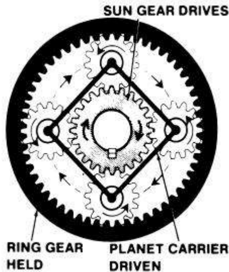
Higo. Higo. 3: Los engranajes planetarios en el rango de reducción máxima (bajo). El engranaje de anillo se lleva a cabo y se obtiene una relación de transmisión más baja
