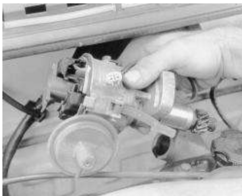
Higo. Higo. 6: ... a continuación, deslice el distribuidor hacia arriba y fuera del motor
