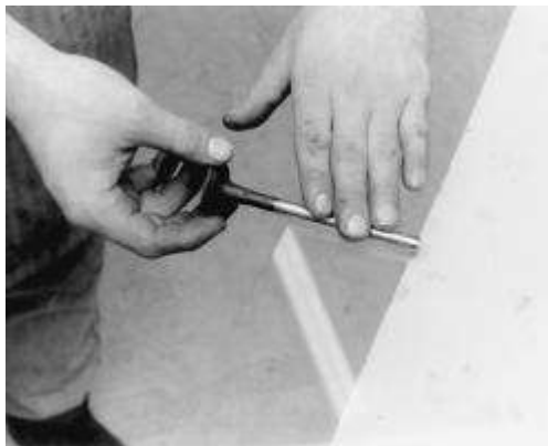
Higo. Higo. 15: vástagos de válvula puede ser enrollado sobre una superficie plana para comprobar si hay curvas
