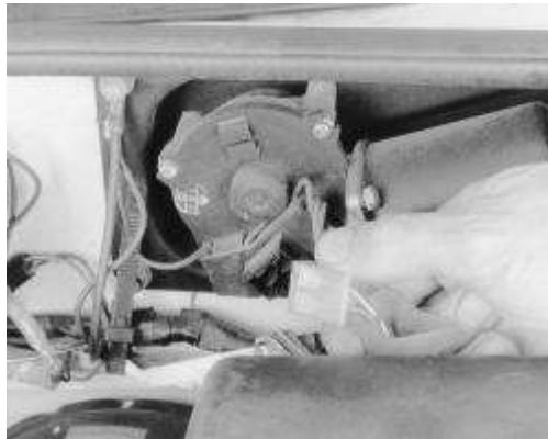
Higo. Higo. 2: Para quitar el motor del limpiaparabrisas, primero desconecte el conector del mazo de cables del motor ...
