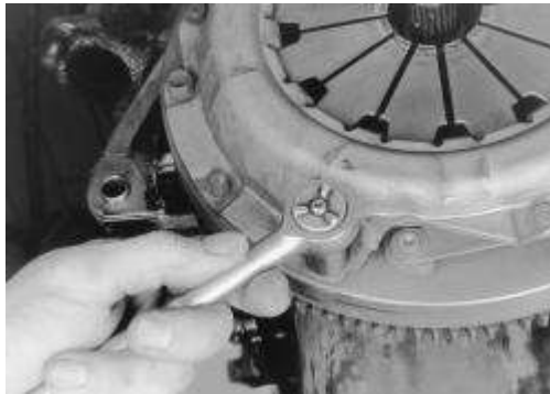
Higo. Higo. 2: Aflojar los tornillos de la placa de presión poco a poco, el uso de varios pases de una secuencia en cruz ...
