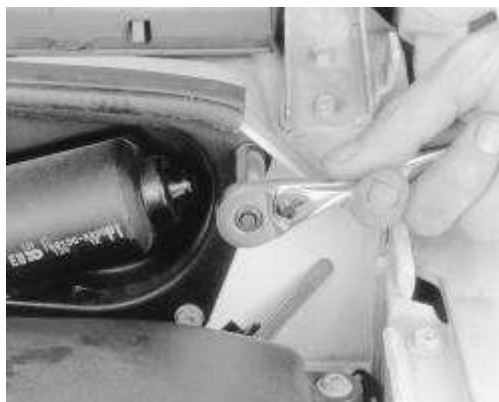
Higo. Higo. 2: Para quitar el motor del limpiaparabrisas, primero desconecte el conector del mazo de cables del motor ...
