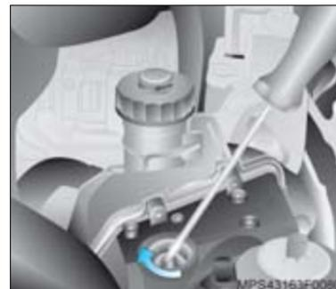
5. Gire el tornillo de ajuste que está ubicado debajo de la tapa; utilice un destornillador (sentido horario) hasta percibir alguna resistencia. El embrague va a quedar aflojado. No siga conduciendo allá de la resistencia para evitar daños al sistema.
