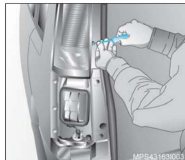
2. Afloje los tornillos de fijación del conjunto de luces del vehículo.
