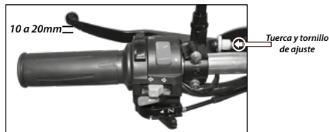
Imagen 21. Ajuste de la palanca del embrague.
