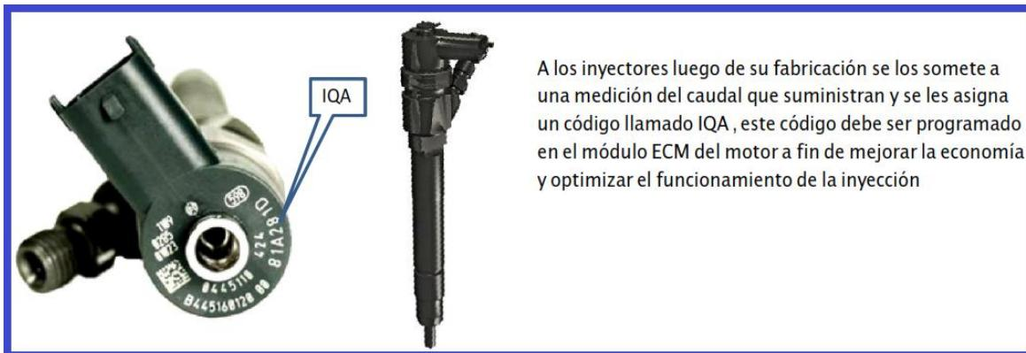
A los inyectores luego de su fabricación se los somete a una medición del caudal que suministran y se les asigna un código llamado IQA , este código debe ser programado en el módulo ECM del motor a fin de mejorar la economía y optimizar el funcionamiento de la inyección
