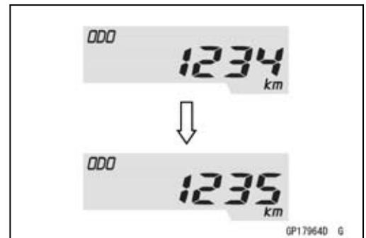
**Comprobación 3-12: Comprobación del medidor de distancia A/B**
