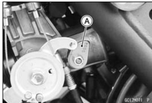
**Inspección del actuador de la válvula del subacelerador**
