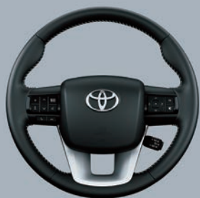
Volante multifunción con control de velocidad crucero y regulación en altura y profundidad. 2
