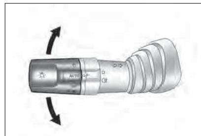
Para desconectar el control automático de las luces, gire el conmutador de las luces a la posición OFF. La palanca volverá automáticamente a su posición normal al soltarla.
