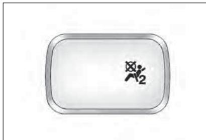
Cuando los airbags están desactivados, se enciende el testigo del airbag del acompañante desactivado en el indicador de estado para recordarle que los airbags para el acompañante y el pasajero sentado inmediatamente detrás del acompañante están desconectados. Dichos airbags permanecerán desactivados hasta que usted vuelva a activarlos.
