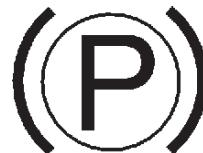
En vehículos con freno de estacionamiento eléctrico (EPB), el testigo del freno de estacionamiento se debería encender brevemente cuando la llave está en la posición ON / START. Si no se enciende, haga que lo reparen para que le advierta si hay un problema.
