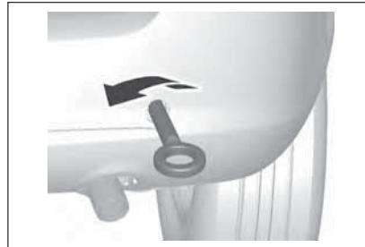
Si utiliza la anilla de remolque trasera, tire siempre del cable o de la cadena en línea recta con respecto a la anilla. No tire lateralmente del gancho. Para evitar daños, no estire el cable demasiado deprisa.
