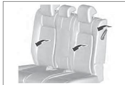
4. El asiento se volcará hacia delante automáticamente y unas varillas de apoyo con sistema de aire comprimido mantendrán los asientos plegados.
