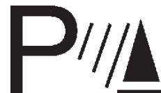
**TESTIGO DE NIVEL BAJO DE LÍQUIDO DEL LAVAPARABRISAS**
