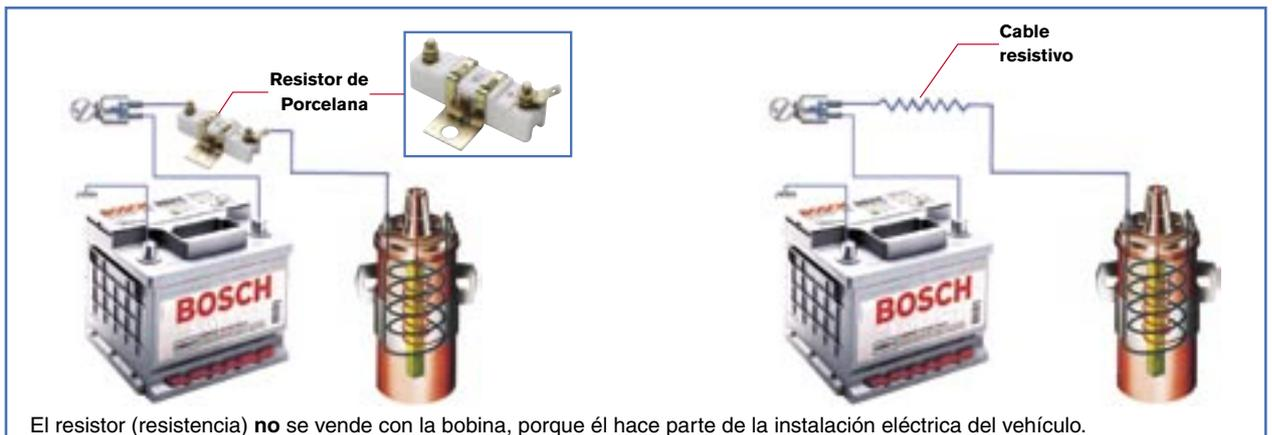
El resistor (resistencia) **no** se vende con la bobina, porque él hace parte de la instalación eléctrica del vehículo.
