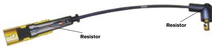
El resistor (resistencia) está instalado dentro de los terminales que están sobre las bujía y también sobre la tapa del distribuidor y de la bobina.
