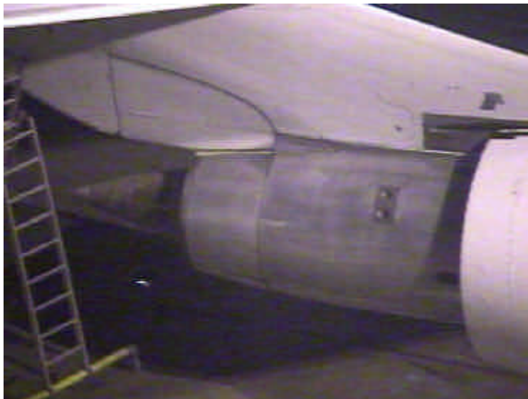
Tobera de salida de uno de los 4 motores de un Boeing 747 "Jumbo"
